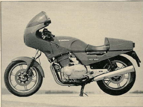
Optisch ist die rote RGS 1000 ein Gemüß (rechts). Weniger erfreulich ist die Bremswirkung der Brembo-Doppelscheibe bei Nase: Sie spricht verzögert an (oben)
