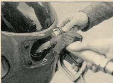
Ungewöhnlich: Tankstützen vorn in der Verkleidung
