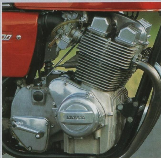
Pur und unverfälscht: die Linksschaltung der „180-Grad“-Motoren. Offiziell nach Deutschland und in die USA gelieferte Maschinen mussten sich hingegen eine Umlenkung hinter dem Getriebegehäuse gefallen lassen
