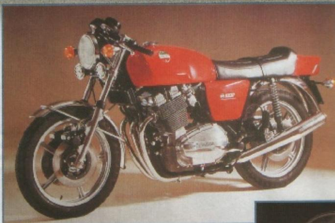
Auspuff und Lenker werden noch geändert, aber solche Kleinigkeiten verblassen angesichts der stattlichen Fahrleistungen: 78 PS schieben den Dreizylinderbrocken nach mehr als zwei Kilometern Anlauf auf exakt gemessene 202,25 km/h. Dass Tester Ernst „Klacks“ Leverkus hier nur Vorfreude anheizt, kann zu diesem Zeitpunkt noch niemand ahnen.
