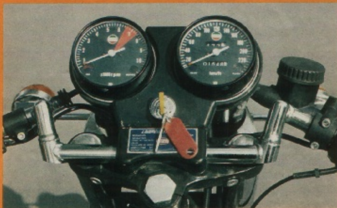
Die „Nippon Denso“-Instrumente stammen aus Japan und sind mit denen der älteren 750er Hondas nahezu identisch.
