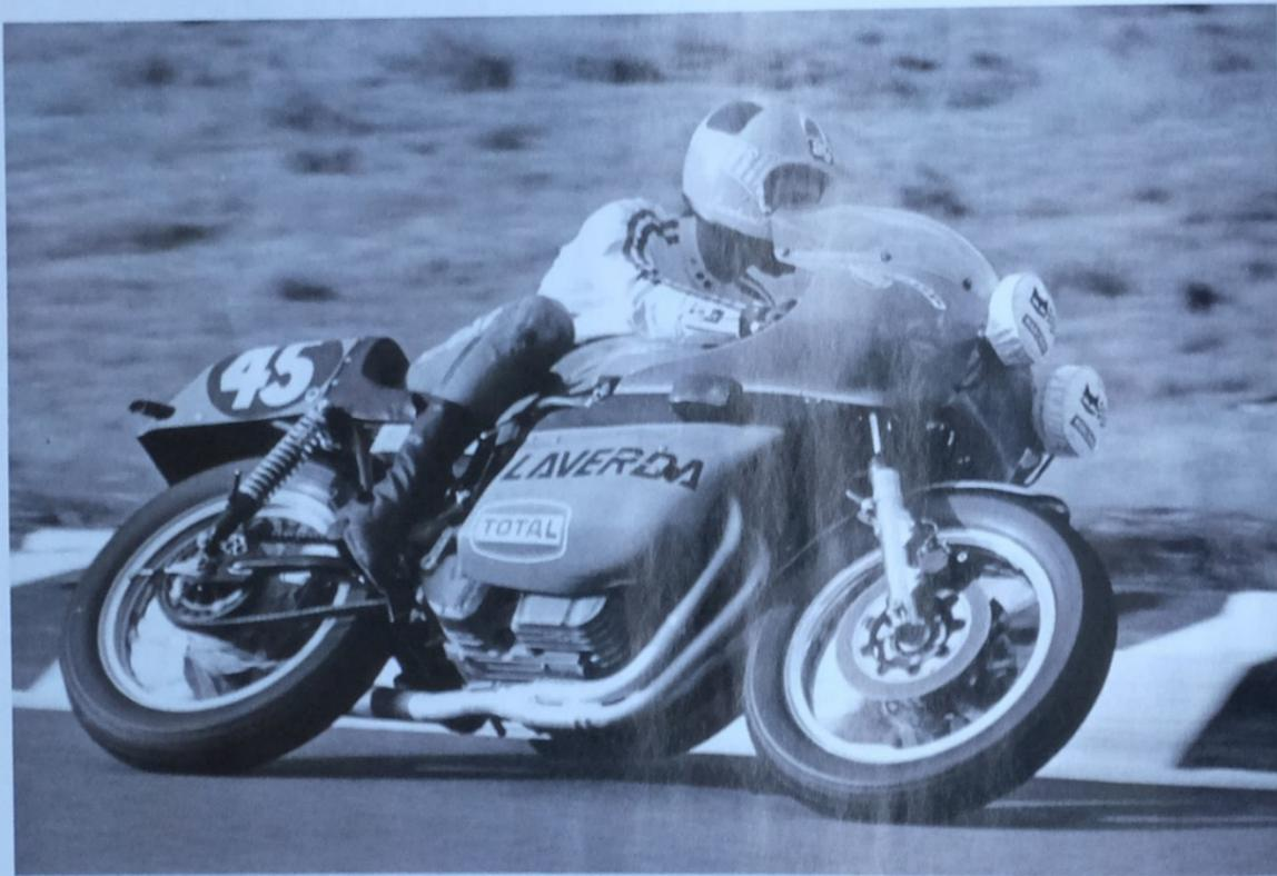
Marco Lucchinelli auf einer Experimentalmaschine mit 120-Grad-Motor beim Bol d'Or im September 1975. Feine Vibrationen stressten die Fahrer und zerstörten etliche Zündboxen
