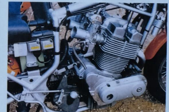
1974 bekam der Werksrenner einen vor dem Motor platzierten Generator für mehr Schräglagenfreiheit
