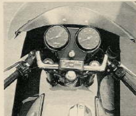
Cockpit mit mehrfach verstellbarem Stummellenker, Instrumente von Nippon Denso
