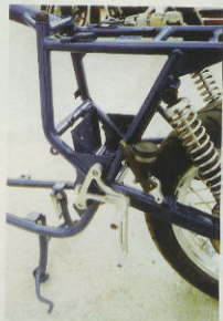
Neuer Batteriekasten, an das Rahmendreieck versetzte Stoßdämpfer-Aufnahme
