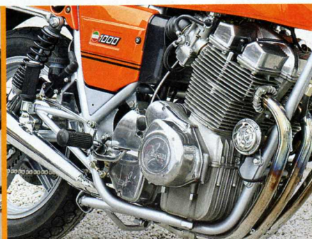
Rahmenrohre und Auspuffanlage führen unter dem Motor hindurch und geben die Sicht auf das komplette Triebwerk frei
