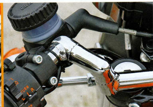
Der ungewöhnliche, über Stirnverzahnungen in fünf Elemente geteilte Lenker lässt sich räumlich nach Belieben verstellen
