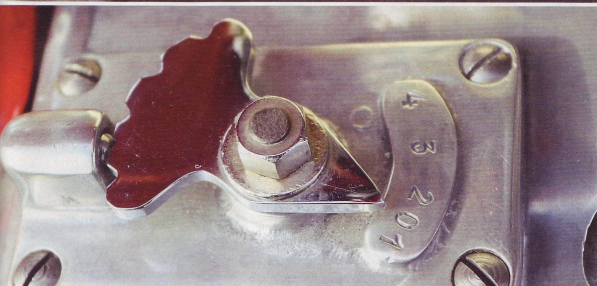
Simpel, aber standfest: das 100 Kubik-Triebwerk mit parallel hängenden Ventilen. Den guten Namen mit Füßen getreten: Laverda-Schriftzug im Gummi der Fußrasten. Zählwerk: der glänzende Ganganzeiger auf dem Getriebe
